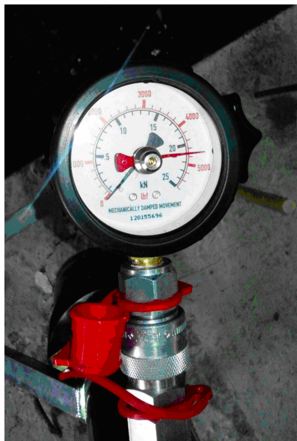
Рисунок 8 – показания манометра испытательной машины при выдергивании СППС. Глубина анкеровки 60 мм
